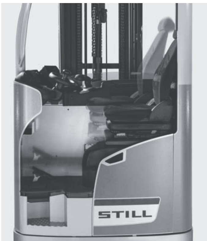
Оптимальная с точки зрения эргономики позиция сиденья благодаря возможности пропорционального регулирования сиденья и ножной платформы
